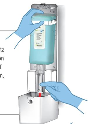
**7** ■ Einstichstelle der keimarmen Flaschenbelüftung auf dem Flaschenboden mit Desinfektion desinfizieren.
