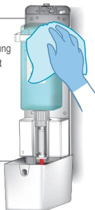
**8** ■ Keimarme Flaschenbelüftung aus dem leeren Gebinde herausziehen und in eine der vorderen, äußersten Ecken des Flaschenbodens einstecken.
