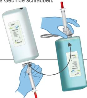
**5** ■ Kontaminationsschutz entfernen, Schlauchdosierpumpe über dem Waschbecken entlüften und Kontaminationsschutz wieder aufstecken.
