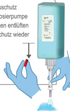
**6** ■ Gebinde mit Kontaminationsschutz im Spender platzieren und Sichtprüfung auf Dichtheit durchführen.
